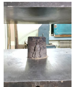
г) характер руйнування зразка
